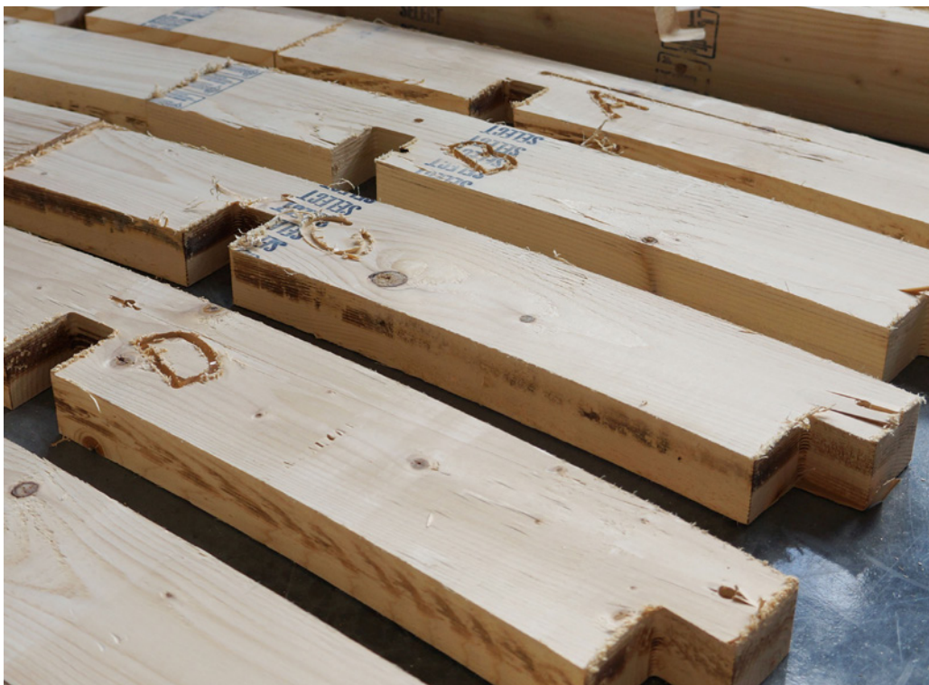
Figure B-4. Résultat des premières découpes avec la CNC
